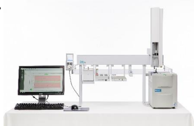
図 1: 超高速 GC 技術を基盤としたフラッシュ GC ノーズ HERACLES II
