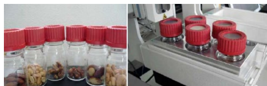
図 2: ナッツの分析に使用した大容量バイアルと温度管理可能なペルチェ式トレイ
