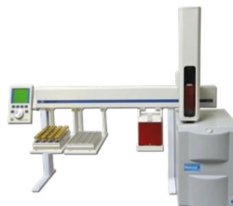
図1: 超高速GC技術をベースとしたフラッシュGCノーズ HERACLES II
