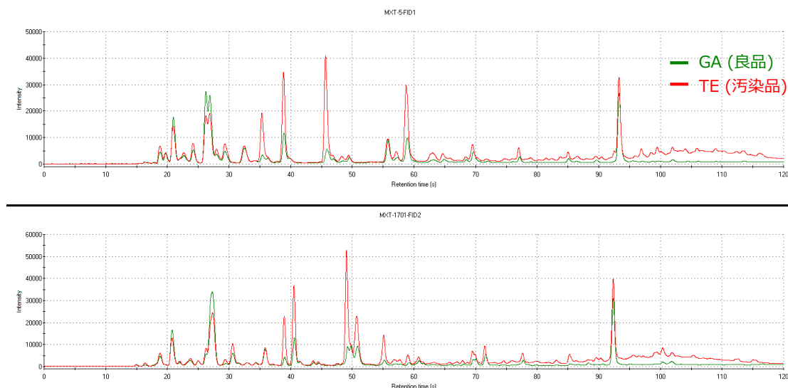
図 2: HERACLES II の2つのカラムで得られた小麦の2サンプル (GA と TE) のクロマトグラム (横軸は保持時間 (秒))
